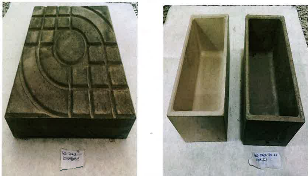
Fig. 4 Piezas prefabricadas obtenidas. Losas y Jardinera
