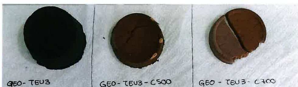
Fig. 2 Muestras geopolimero con diferentes composiciones
